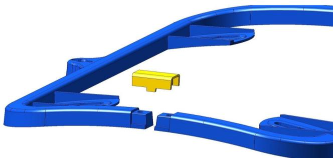
Questo giunto permette un facile montaggio del cappellotto sul serbatoio in funzione.
