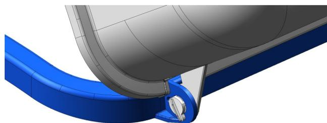
Questo nuovo assemblaggio è facile e veloce. Una volta montato sul serbatoio il cappellotto risulta impossibile da dividere dal telaio.
