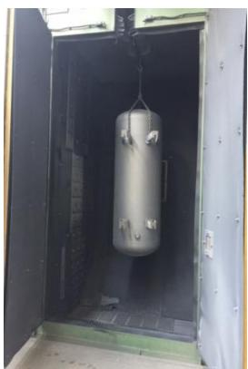
Il rispetto del grado di sabbiatura e della rugosità superficiale sono fondamentali per l'aderenza del rivestimento epossidico sul substrato metallico. In conformità alla norma ISO 8501-1 il serbatoio viene sabbiato con un grado di finitura superficiale SA 2,5 richiesto dalle leggi vigenti.
