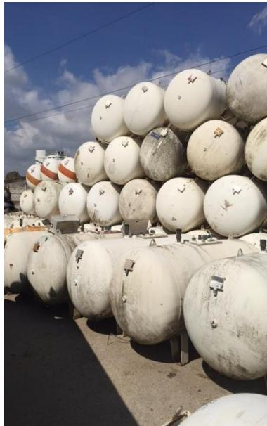
I serbatoi in arrivo per la riqualifica, sono depositati in un'apposita area per poi procedere alla depressurizzazione e allo smontaggio di tutti gli accessori, per poi essere prelevati e condotti alle fasi successive di lavorazione.
