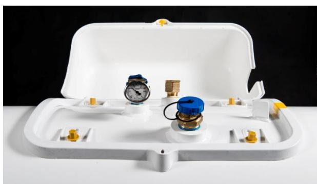
Dopo il collaudo si effettua il montaggio delle strumentazioni di sicurezza previste dalle leggi vigenti, e la pressurizzazione per la successiva prova di tenuta degli strumenti. La pressurizzazione del serbatoio viene effettuata a 7 bar con aria adeguatamente essiccata, onde evitare che l'umidità presente nell'aria possa condensare all'interno del serbatoio.
